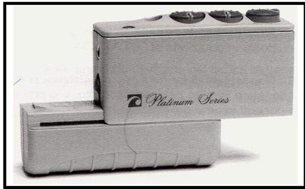
**IMPORTANTE:** durante le operazioni di accensione, regolazione del volume e spegnimento dell'apparecchio l'antenna-microfono deve essere staccata. Il pomello del volume è molto sensibile e un suo inavvertito spostamento potrebbe causare dolore (questo non accade negli apparecchi in cui il volume è stato bloccato).
